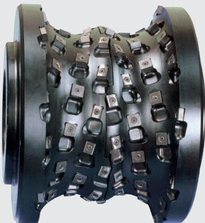
Profilvorfräser für Drehkolben (Rootsgebläse) 2teilig, Ø 312 x 260 x Ø 120 mm, 92 Wendeplatten Profile roughing cutter for rotary pistons (Roots blower) 2-section, 312 mm dia. x 260 x 120 dia., 92 indexable carbide inserts
