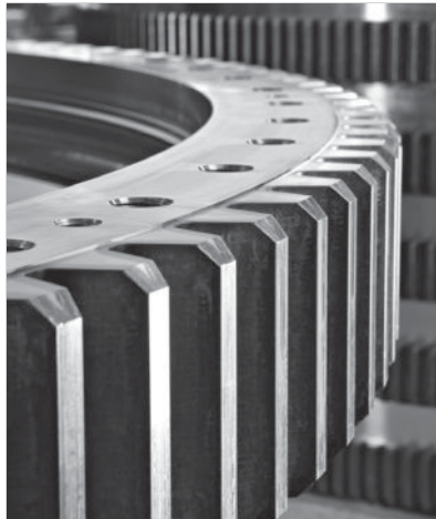
AV Schrappen Grob Coarse roughing of external gears
