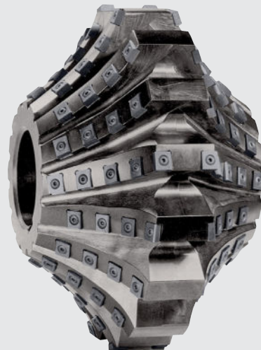
Zahnform-Scheibenfräser m 50, E \nless 20^\circ , 11 Zähne, ohne Fußrundung, Ø 295 x 190 x Ø 80 mm, 136 Wendeplatten Circular-type gear profile cutter m 50, 20° p.a., 11 teeth, without roof radius, 295 mm dia. x 190 x 80 dia., 136 index- able carbide inserts
