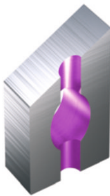
Сверление пересекающихся отверстий
