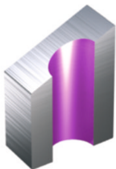
Засверливание в наклонную поверхность
