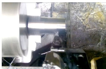
Титан BT3 Наружная обработка Режимы резания: V_c = 290 м/мин f = 0,1 мм/об a_p = 0,1-0,5 мм
